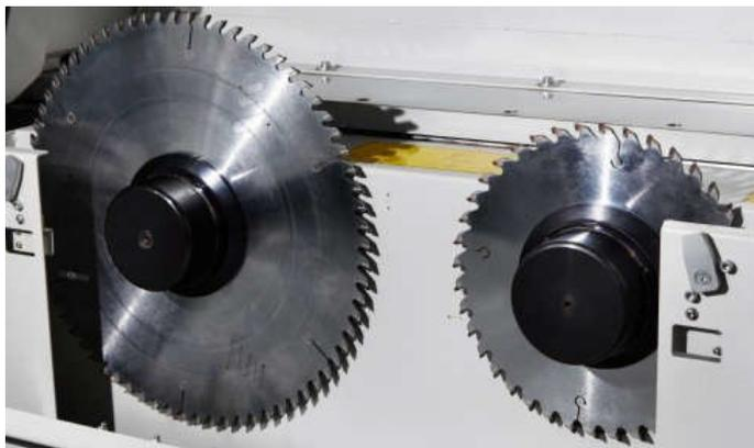
пилы контролируются компьютером. Пилой можно управлять непосредственно с рабочего экрана станка, нет необходимости останавливаться или использовать специальные инструменты, что значительно повышает эффективность выравнивания инструмента и резки.
