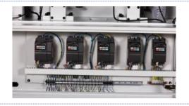
Все высокочастотные двигатели (за исключением блока очистки и полировки) управляются независимыми преобразователями частот известных брендов.
