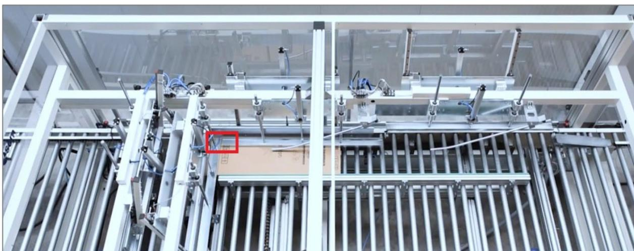
Modbox 410 обеспечивает автоматическую склейку с трех сторон коробки, после того как оператор или робот поместил продукцию в эту коробку.
