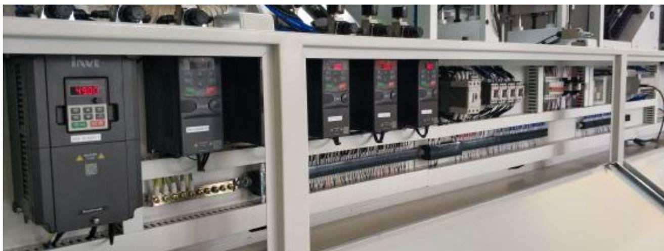
Все высокочастотные двигатели (за исключением блока очистки и полировки) управляются независимыми преобразователями частот известных брендов.
