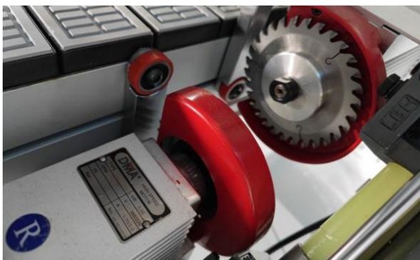
Торцовочный узел оснащен индивидуальными высокочастотными двигателями марки DMA, номинальная скорость вращения: 12000 об / мин. Отличается надежностью и длительным сроком службы.
